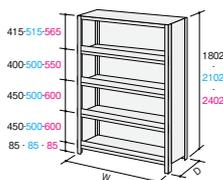
■C型ボックス棚 棚板1段の最大積載質量(等分布) 120kg
