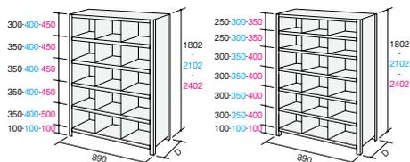
■D型ボックス棚 棚板1段の最大積載質量(等分布) 100kg
