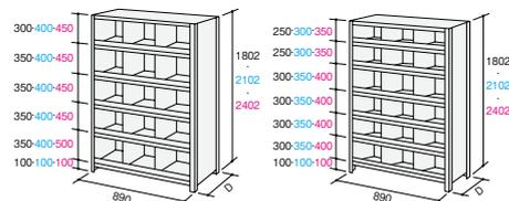
■E型ボックス棚 棚板1段の最大積載質量(等分布) 100kg
