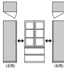
※エンドパネル及び、ロッカーは、連結方向の側面のみに連結用穴が開いています。
