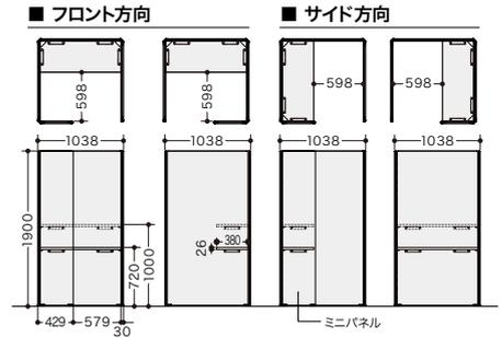
テーブルとミニパネルの取付位置は施工時に選択できます。
