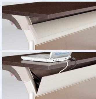
幕板上部は開閉可能な配線ダクトになっており、乱雑になりがちな配線コードを簡単に収納できます。また、天板とカバーが連動して、天板はね上げ時には自動で閉まります。
