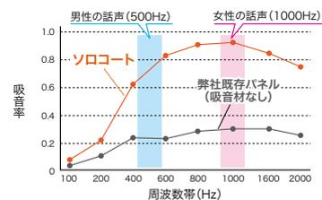
吸音効果を備えたパネル構造で、特に男性と女性の話し声である周波数帯(500~1000Hz)の吸音率が高く、周囲への音漏れを軽減してくれます。
