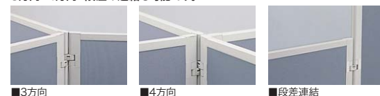
①パネルにジョイントを取り付ける。 ②パネル同士を連結し、ロックプレートを差し込む。 取り外しは金具を差し込み、ロックプレート抜き、ジョイントを離す。
