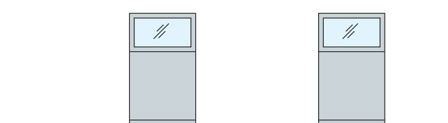
上面ガラス (5mm厚透明ガラス)・下面パネル ㊦
